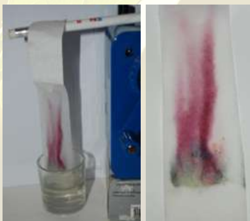
Figura 2. (Izda.) Disposición de la cromatografía en papel. (Drcha.) Resultado de la cromatografía.
