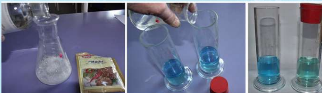
Primero se mezcla el bicarbonato con el vinagre. Se introduce el dióxido de carbono generado en una probeta que contiene agua con un indicador. Se observa el cambio de color. Imagen: Ole Ahlgren.
