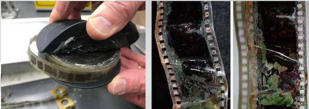
Degradación de una película de acetato de celulosa por el “síndrome del vinagre”(NZMS (izda.); Fílmoteca Nacional Española (drcha.)).
