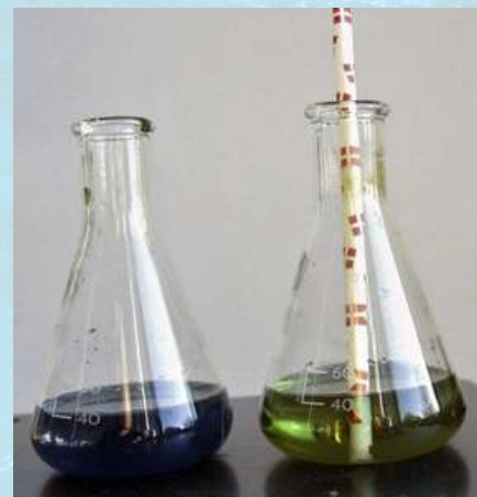
Agua e indicador azul de bromotimol con (azul) y sin (verde) dióxido de carbono. Imagen: Ole Ahlgren
