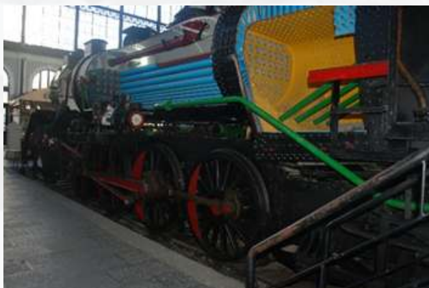
Fig. 2. Locomotora 141 Mikado. en ella se aprecia el hogar y la caldera, así como los “tubos de humo”, dispositivo de calefacción que introduce el “calor” dentro de la caldera.
