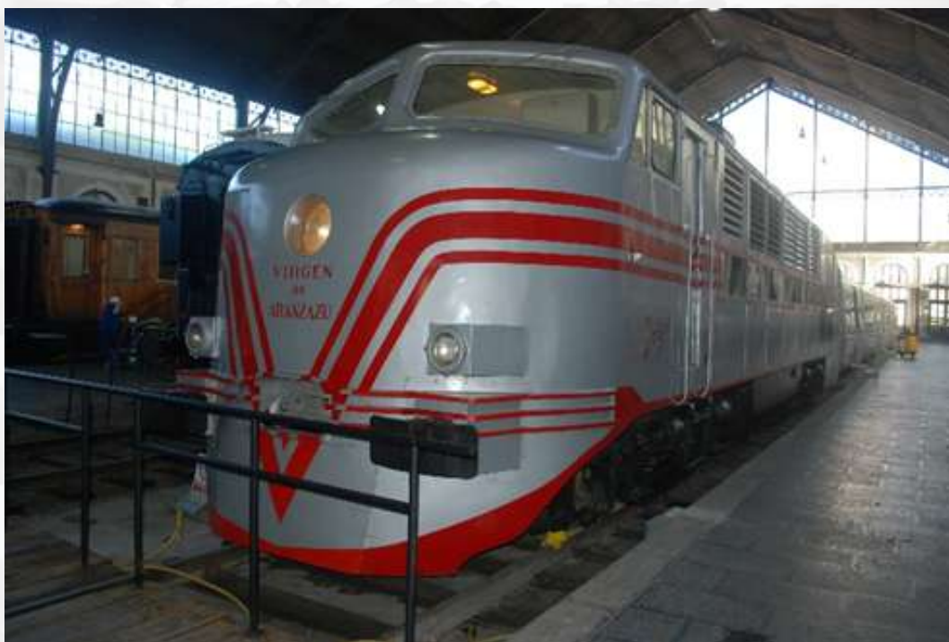
Fig. 6. Tren Talgo II. Para asegurar su ligereza está fabricado con aluminio.
