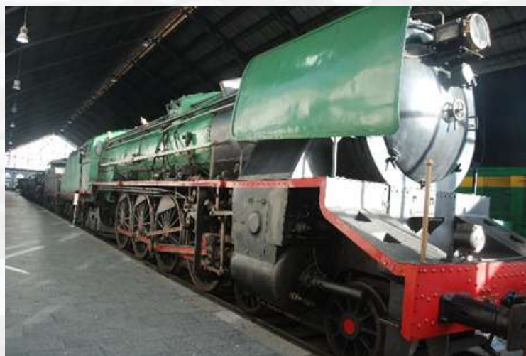
Fig. 3. Locomotora 242 “Confederación” La locomotora de vapor construida en serie en Europa. Diseño de José Augé de MTM.
