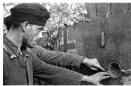
Soldados inspeccionando un impacto en el blindaje de un Tiger I.
