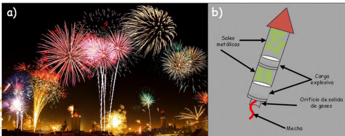
Figura 1. Espectáculo de fuegos artificiales (a), y esquema de un cohete pirotécnico (b)
