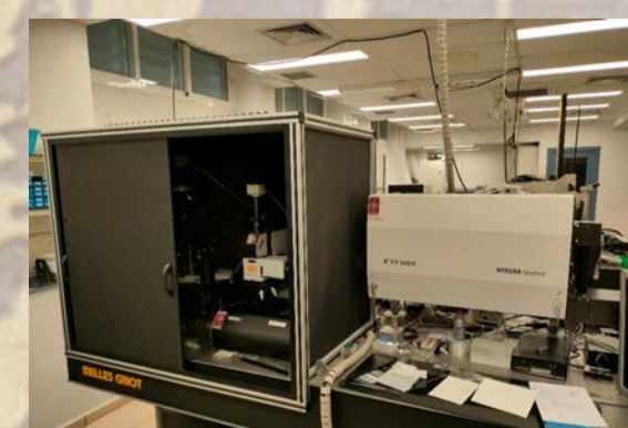
Espectrómetro Raman acoplado a un microscopio óptico y a un microscopio de fuerza atómica (AFM)
