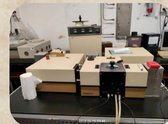
Fluorímetro con resolución temporal (1995)
