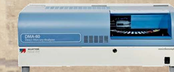
Equipo DMA-80 (2024) para análisis de Hg
