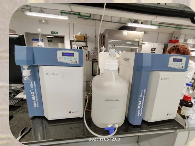
Aparato de purificación de agua por intercambio de resinas (1997)
