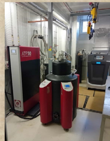
Licuefactor de helio (2023). Capaz de producir hasta 24 litros de helio líquido por día
