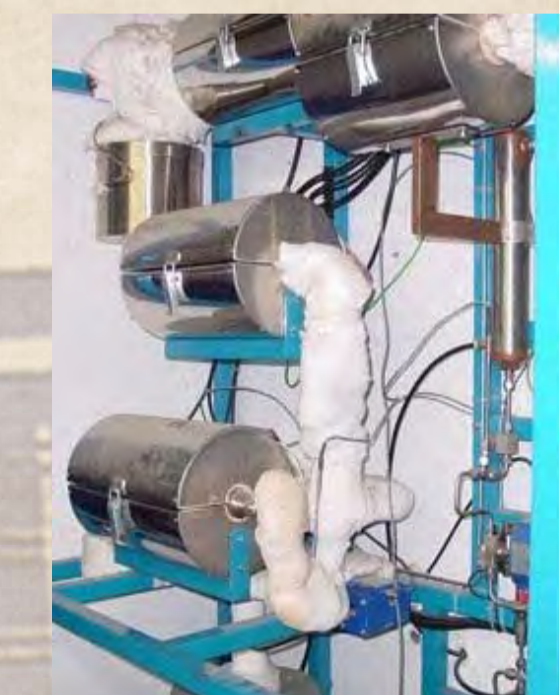
Planta Wet Air Oxidation (WAO)
