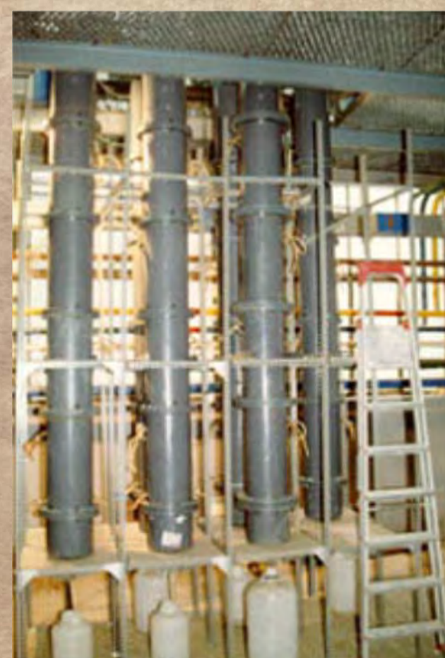
Columnas de biolixiviación. Tratamiento de uranio a escala semipiloto.
