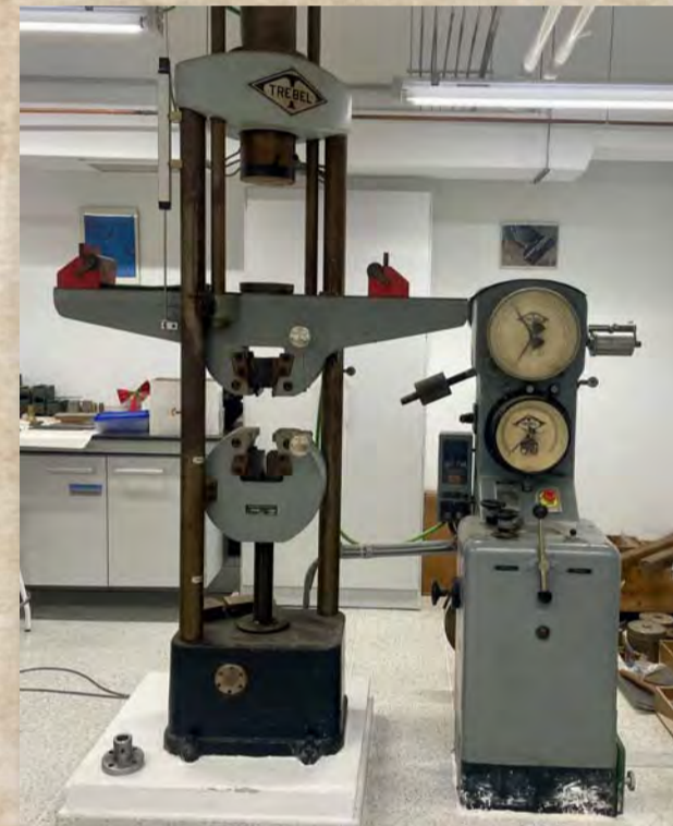
Máquina de tracción máquina universal para ensayos mecánicos
