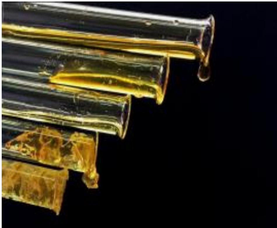
**¡EL GEL ESTÁ EN SU PUNTO!** Un material elástico es aquel que posee la capacidad de recuperar su forma original cuando cesa una fuerza aplicada sobre él. Sin embargo, en el caso de los materiales viscosos, la deformación producida es permanente. Cuando un material combina ambos comportamientos, a éste se le denomina material viscoelástico. En el momento en que la contribución del comportamiento elástico se iguala al viscoso, se dice que el material está en el punto de gel.
